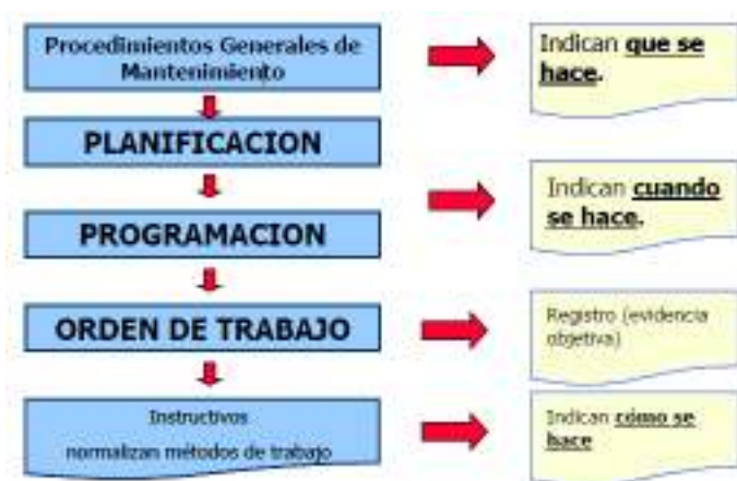
Gráfico No. 8 TRANSBA SA. Estructura del sistema de gestión de mantenimiento
