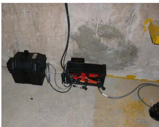
**Figura 2.** Acelerógrafos instalados en la presa
