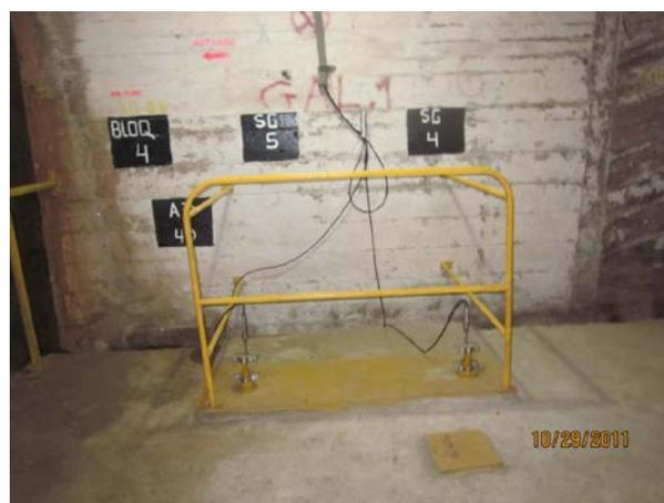
**Figura 3.** Equipos Piezómetros
